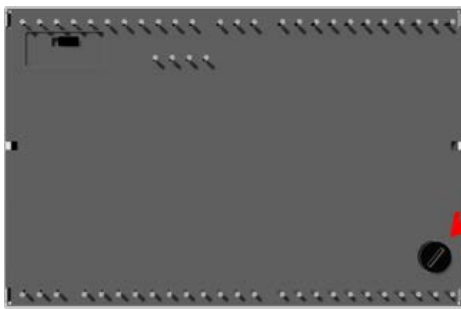
Glasrohrsicherung 20x5 mm, 6,3A flink
