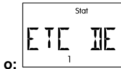
o: Colector – desconexión de exceso de temperatura está activada
