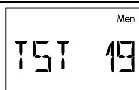
Namještanje probnog analognog stupnja
