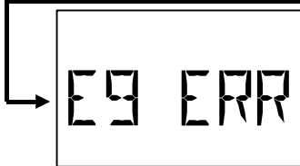
Wartość zewnętrzna 9 Wyświetlana jest tylko wtedy, gdy aktywny jest zewnętrzny przewód transmisji danych
