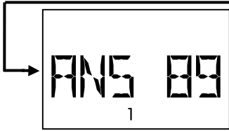
Analogstufe, nur eingeblendet, wenn Steuerausgang aktiviert
