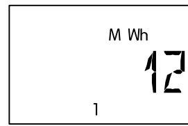
MWh, nur eingeblen- det, wenn Wärmemengen-zäh- ler aktiviert
