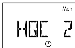
Heat quantity meter 2
