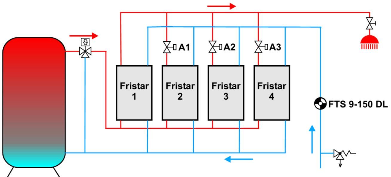
Die Ausgangsbezeichnungen für die Sperrventile **A1** – **A3** beziehen sich auf den Regler UVR67.
