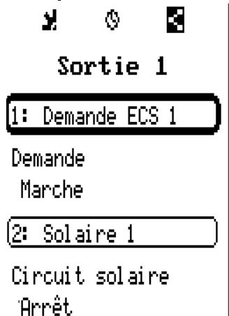
Dans cet exemple, la sortie 1 de 2 fonctions est commandée, cette sortie étant activée au même moment par la fonction 1 (eau chaude sanitaire).
