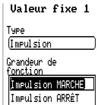
Sélection de la grandeur de fonction : lors de l'activation, une impulsion MARCHE (de ARRÊT sur MARCHE) ou une impulsion ARRÊT (de MARCHE sur ARRÊT) est générée au choix.
