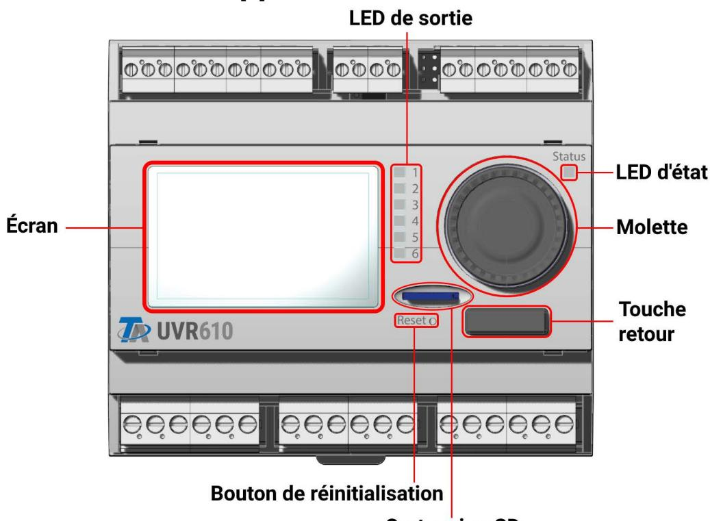
L'**écran** permet de naviguer dans le compteur, pour programmer des fonctions, consulter des valeurs, accéder à d'autres appareils, etc.
