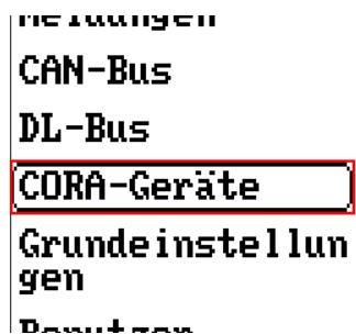
Ce menu permet de régler et de paramétrer par radio des appareils CORA ainsi que de consulter les valeurs transmises.
