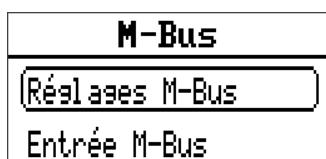
Les réglages généraux de l'appareil pour le bus M et les adresses des appareils à bus M sont définis dans le menu M-Bus/Réglages M-Bus.
