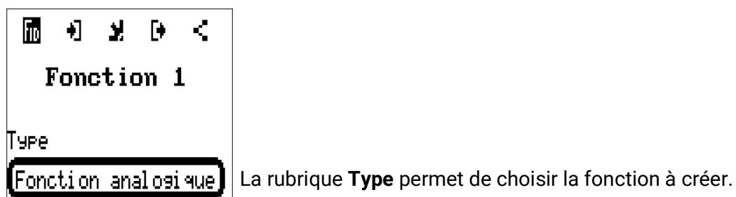
La ligne du haut dans le menu Fonction permet d'accéder à **fiD** (type et désignation), aux **variables d'entrée, paramètres, variables de sortie et liaisons**.
