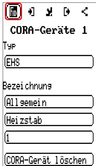
le **type** permet de déterminer le type d'appareil avec lequel une connexion doit être établie.
