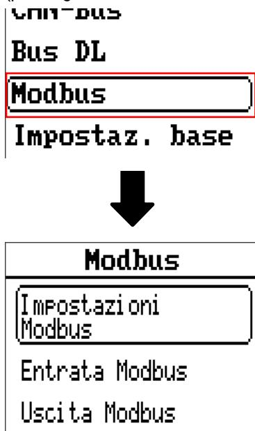
Le régulateur UVR610-MODB peut être utilisé comme maître ou esclave sur Modbus RTU485. Tous les réglages de fonctionnalité Modbus ainsi que le paramétrage des entrées et sorties sont effectués via ce menu.
