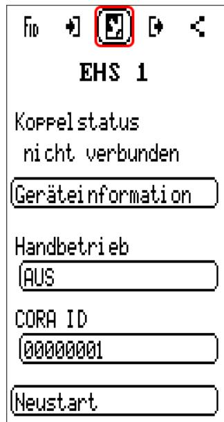
**État du couplage** indique si la liaison radio est établie avec l'appareil.
