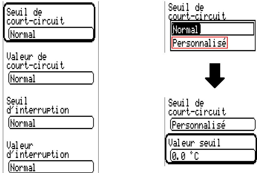
Cette sélection n'est affichée qu'en cas de contrôle capteur **actif** et pour la grandeur de mesure **Utilisateur**.
