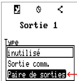
Ces sorties peuvent être utilisées comme simples sorties de commutation ou comme **paire de sorties** ! avec la sortie de commutation **qui suit** (p. ex. commande d'un entraînement mélangeur).
