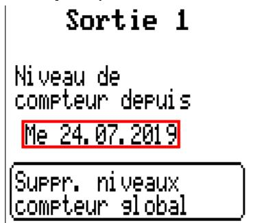
Après l'effleurement du champ de commande, le système demande s'il faut effacer tous les niveaux de compteur ainsi que Veille des compteurs d'heures de service et d'impulsions. Les niveaux de compteur Aujourd'hui, Dernier service et Service actuel ne sont pas effacés.
