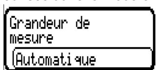
Si « **Personnalisé** » est sélectionné, il est possible de choisir sa propre unité, une correction de capteur ainsi qu'une fonction de surveillance si la fonction Contrôle capteur est activée.
