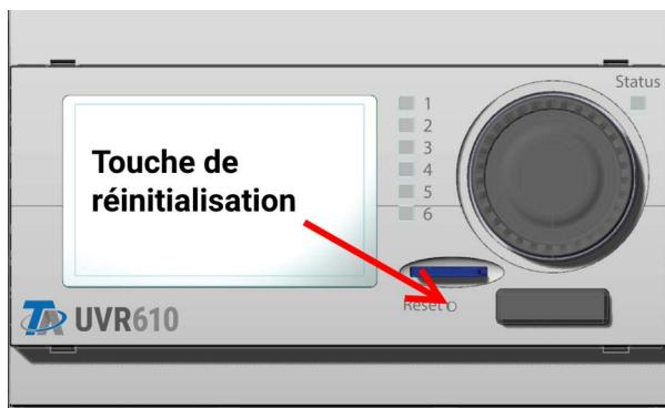
Pour redémarrer le régulateur, appuyez brièvement sur la touche de réinitialisation (avec un stylo fin) à l'avant du régulateur et relâchez-la avant que le signal sonore ne s'arrête (= réinitialisation).
