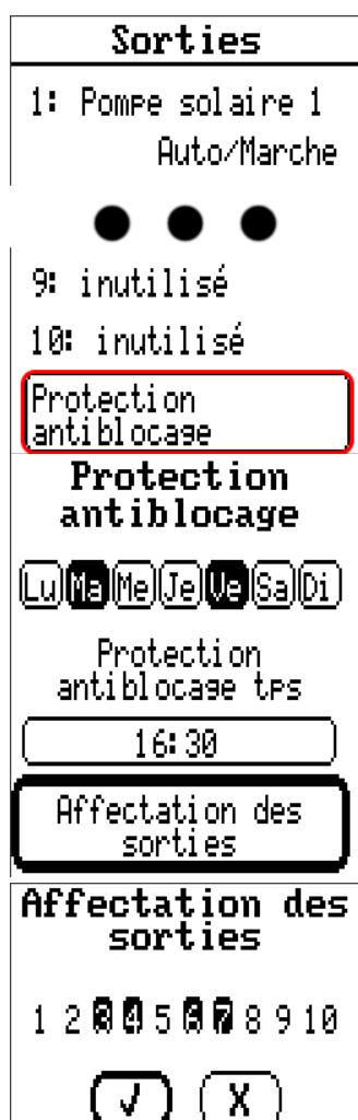
Les pompes de circulation qui ne fonctionnent pas pendant un certain temps (p. ex. : pompe du circuit de chauffage pendant l'été) ont souvent des problèmes de démarrage en raison de la corrosion interne. Ce problème peut être évité en mettant périodiquement la pompe en marche pendant 30 secondes.
