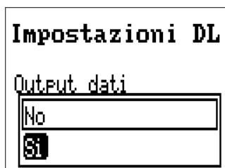
Con questi tasti è possibile attivare e disattivare l'**output dati** per la **raccolta dati** mediante bus DL e per le visualizzazioni nel sensore ambiente **RAS+DL**. Per la Raccolta dati DL si usa il C.M.I.
