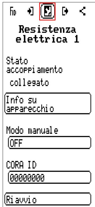
**Stato di accoppiamento** indica se è stabilita la connessione wireless con il dispositivo.
