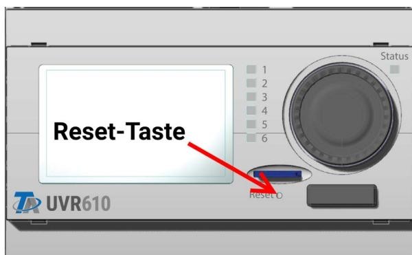
Durch **kurzen** Tastendruck (mit einem dünnen Stift) auf die Reset-Taste auf der Vorderseite des Reglers und Loslassen **bevor** der Pfeifton endet startet der Regler neu (= Reset).
