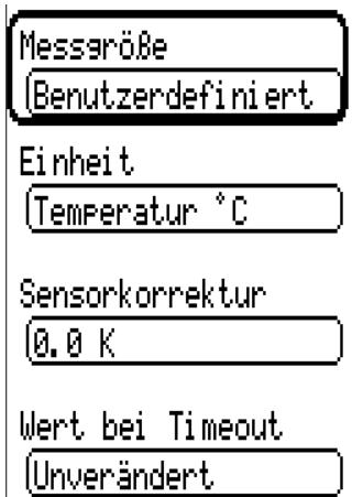
Jedem M-Bus-Eingang wird eine **Einheit** zugeordnet, die abweichend zur Einheit des M-Busgeräts sein kann. Es steht eine Vielzahl an Einheiten zur Verfügung.
