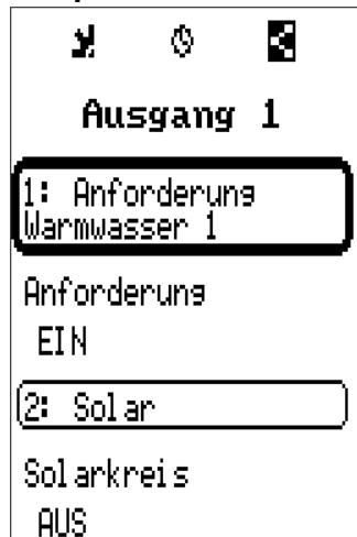
In diesem Beispiel wird der Ausgang 1 von 2 Funktionen angesteuert, wobei er gerade von der Funktion 1 (Warmwasser) eingeschaltet wird.
