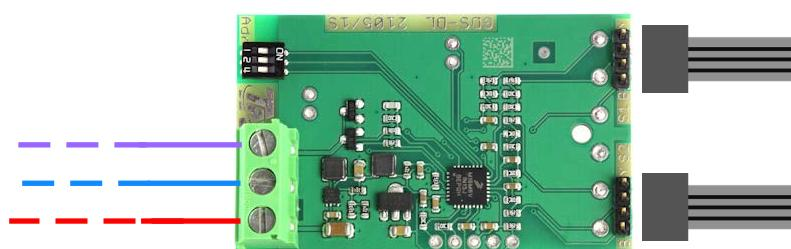
Die Grundlagen der DL-Busverkabelung sind in den Montageanleitungen frei programmierbarer Regler ausführlich beschrieben. Die Polung der Datenleitung ist bei diesem Gerät **nicht** vertauschbar.
