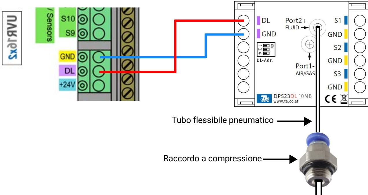
Le basi del cablaggio del bus DL sono descritte in dettaglio nelle istruzioni di montaggio dei tre regolatori programmabili. L'assegnazione dei poli della linea dati è intercambiabile.
