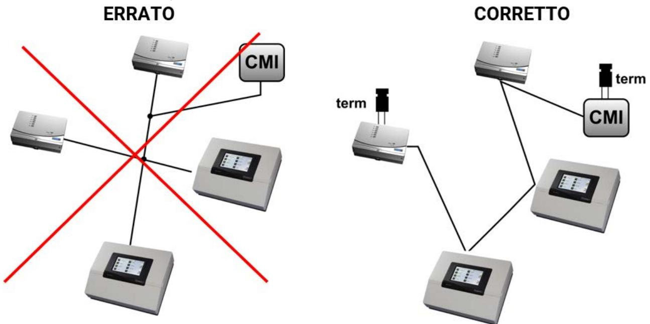
Esempio: Collegamento di tre nodi di rete (NOR) con cavo a 2x2 poli e terminazione dei nodi di rete terminali (rete interna a un edificio)
