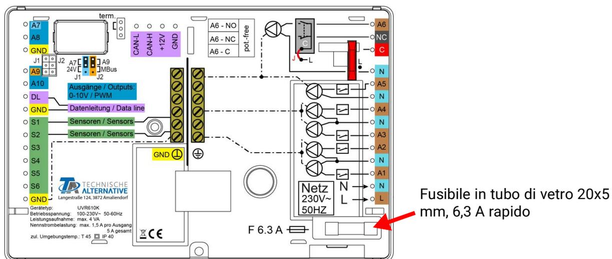
**Valori temperatura realistici, ma comportamento irregolare delle uscite:** sono presenti impostazioni errate o difetti sui morsetti. Se è possibile attivare e disattivare le uscite in modalità manuale e l'apparecchio funziona, si devono controllare tutte le impostazioni e i morsetti.
