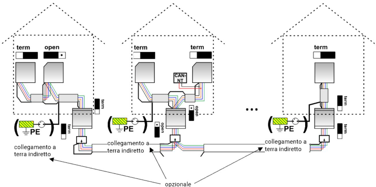
**Lunghezza max. cavo: a seconda della baud rate impostata per il CAN-BC2**
