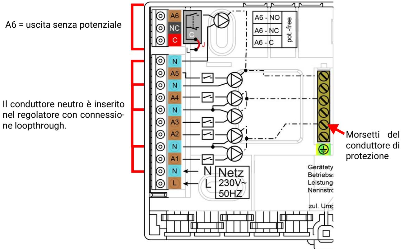
Il carico di corrente massimo delle uscite si ricava dai **dati tecnici**.
