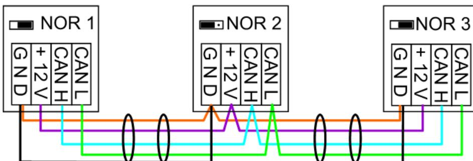
Sulla prima e ultima utenza di ogni rete CAN deve essere predisposto un attacco bus da 120 Ohm (= **terminazione**). Ciò si ottiene mediante un ponte innestato **sul retro del regolatore**). In una rete CAN sono quindi presenti sempre due resistenze terminali (una su ogni estremità). Non sono ammessi stub o cablaggi CAN a stella!
