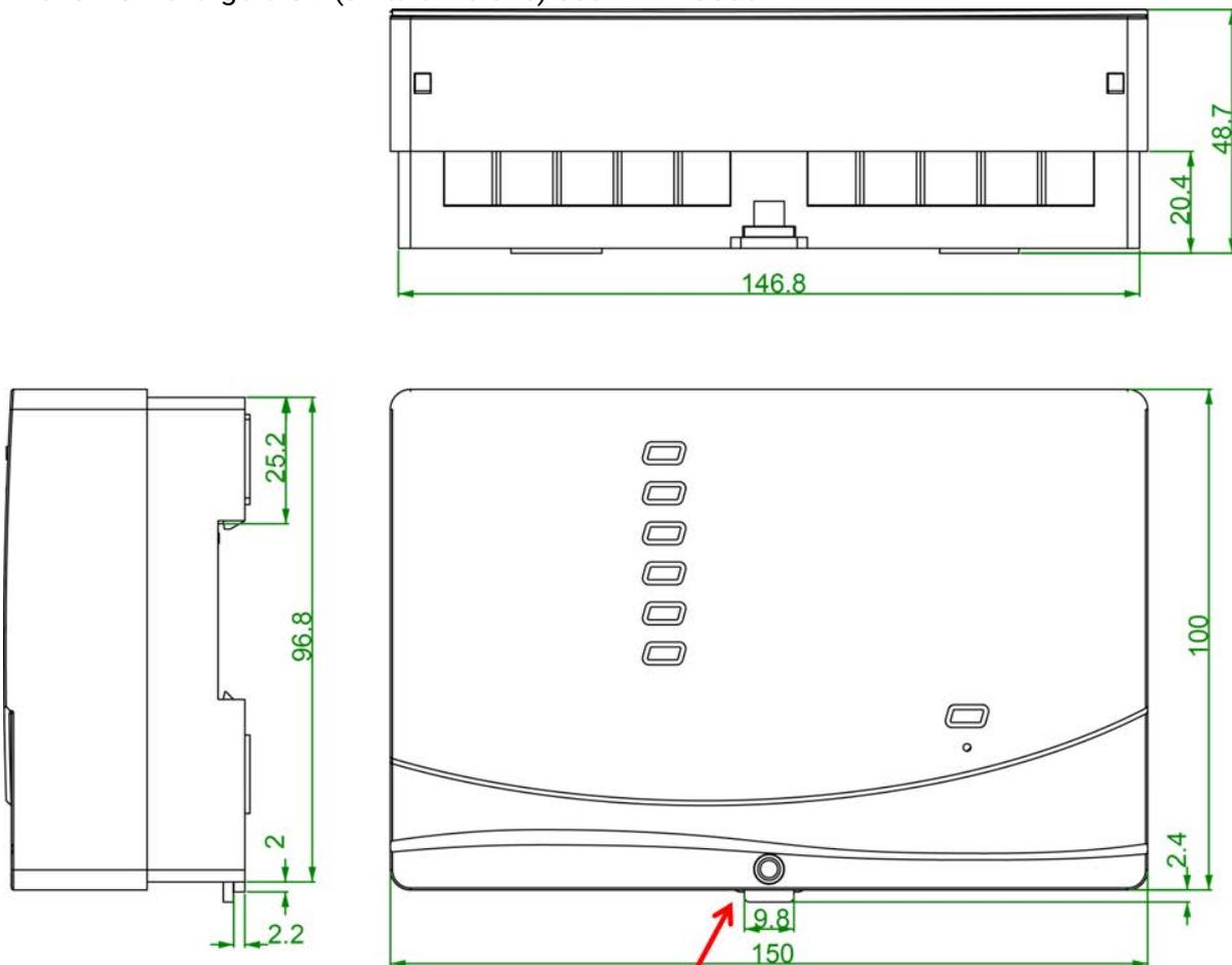
Sblocco per fissaggio a
