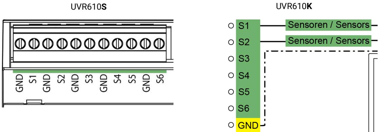
Il collegamento dei sensori si effettua sempre tra il rispettivo morsetto (**S1 – S6**) e la massa del sensore (**GND**). Nella base c'è una barra di massa che deve essere collegata al morsetto **GND** prima di eseguire la morsettatura dei sensori.
