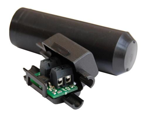
Der AC/DC Konverter wurde zur Erfassung von 230VAC - Signalen in Verbindung mit den UVR - Reglern entwickelt. Mit Hilfe dieses Sensors kann ein externes 230VAC - Signal von UVR - Reglern detektiert werden. Der Sensoreingang des Reglers muss dazu auf Digital gestellt werden. Liegen an den Klemmen des AC/DC-Konverters 230VAC an, so wird am Regler EIN angezeigt, liegt keine Spannung an, wird am Regler AUS angezeigt.
