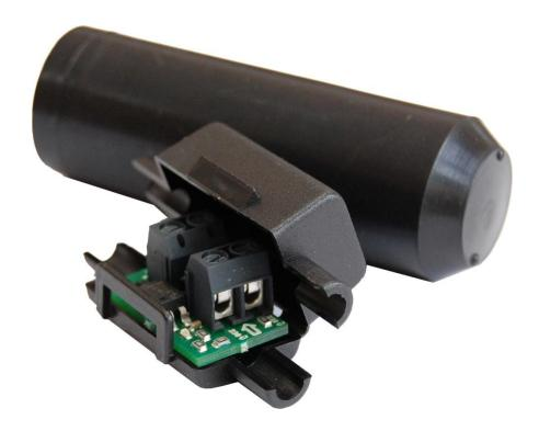
Le convertisseur CA-CC a été conçu pour le captage de signaux 230VCA en liaison avec les régulateurs UVR. Cette sonde permet de détecter un signal 230VCA externe des régulateurs UVR. Pour cela, l'entrée de la sonde du régulateur doit être réglée sur « Digital ». Dès que les bornes du convertisseur CA-CC sont mises sous 230VCA, le régulateur indique ON. Il indique OFF en cas d'absence de tension.
