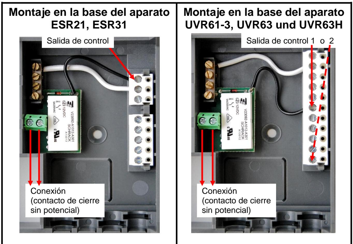
El módulo de relé se emborna a la masa del sensor y a una salida de control según la figura anterior. Para el regulador ESR31 se incluye en el embalaje la tira de toma de tierra de 4 polos.
