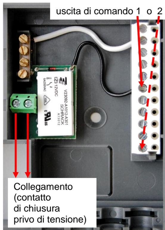
Il modulo relè viene collegato alla massa del sensore e ad una uscita di comando secondo le figure riportate in alto. Per il regolatore ESR31 è compresa nella fornitura la barra di massa a 4 poli.
