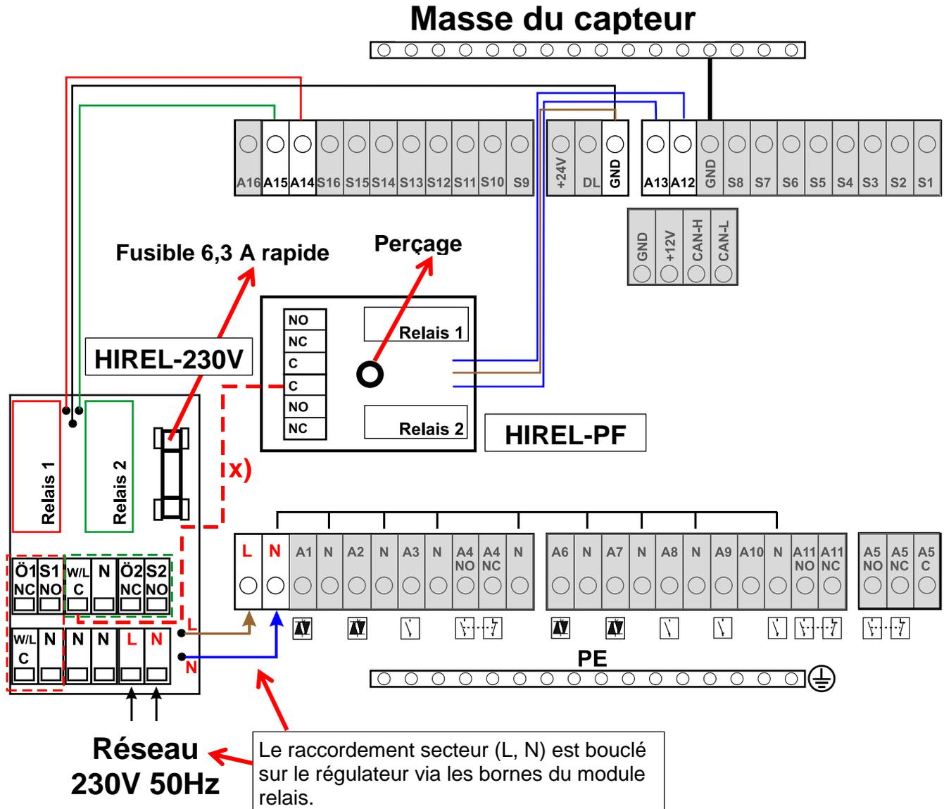
**x)** Grâce à cette liaison, les contacts du relais peuvent relier électriquement le conducteur externe (230 V). Les sorties du relais ne sont ainsi plus libres de potentiel. Elles sont protégées par le fusible de l'HIREL-230V.
