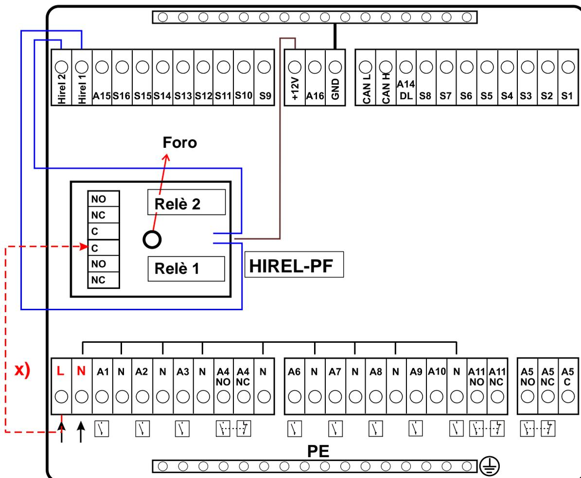
**x)** Questo collegamento permette di collegare i contatti relè con il conduttore esterno (230 V). In questo modo le uscite relè non sono più senza potenziale.
