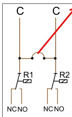
**Foro:** I contatti relè - **senza collegamento x)** - sono senza potenziale, dove le due origini (C) sono collegate in fabbrica.
