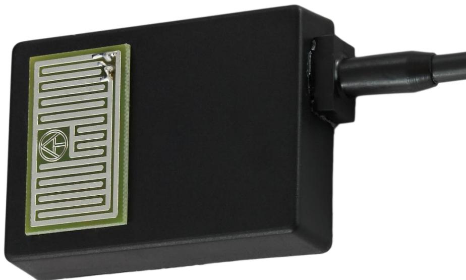
El sensor de lluvia RES01 se ha desarrollado para tareas de medición en función de las condiciones atmosféricas (p. ej., abrir y cerrar las ventanas de un invernadero). El amplificador de medición transforma la señal del sensor en un valor de temperatura. La temperatura seca es de aprox. 90°C y puede bajar un poco debido a la polución. El umbral de humedad debería definirse aprox. 20°C por debajo de la temperatura seca indicada.
