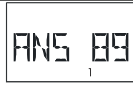
Analogstufe nur eingeblendet, wenn Steueraus- gang aktiviert
