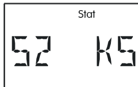
Fehler Sensor 2 (Kurzschluss)
