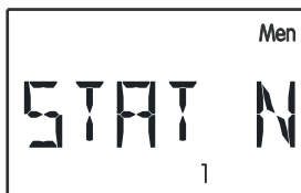
Fehlermeldung (bei Fehler Umschal- tung von 0 auf 10V)
