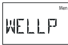
Wellenpaket oder Phasenanschnitt
