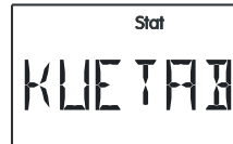
Kollektor – Übertemperaturabschaltung oder Legionellenfunktion aktiv (kein Fehler aufgetreten)
