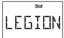
Kollektor – Übertemperaturabschaltung oder Legionellenfunktion aktiv (kein Fehler aufgetreten)
